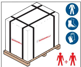
La machine est transportée sur des palettes avec d'autres machines et à l'intérieur de cartons; le tout étant fixé aux palettes au moyen des courroies appropriées.
